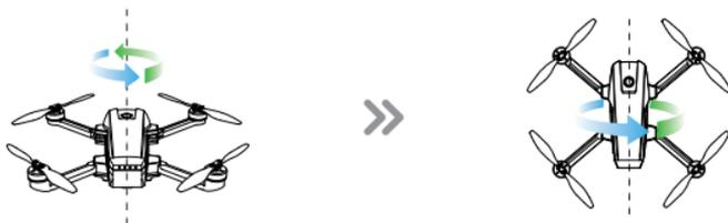
Halten Sie die Drohne horizontal und drehen Sie die Drohne in 3 vollständigen Kreisen. Wenn der Vorgang abgeschlossen ist, blinken die grünen LED-Leuchten.
